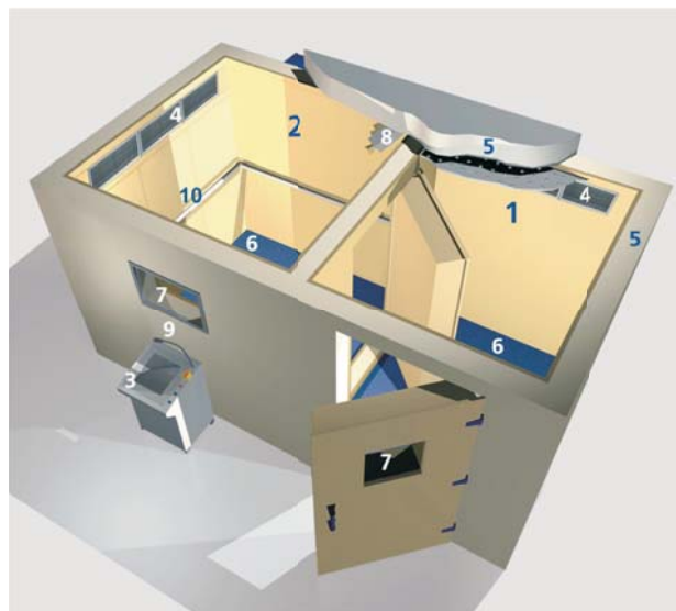
Рис. 6. Схематическое изображение воздушной криосауны «КриоСпейс2К» 1 – предкамера, 2 – рабочая камера, 3 – пульт управления, 4 – решетки испарителя для подачи холодного осушенного воздуха, 5 – многослойная термо- и звукоизоляция, 6 – специальное безопасное покрытие пола, 7 – окна визуального контроля, 8 – видеокамера, 9 – аудиосвязь, 10 – поручни безопасности.
