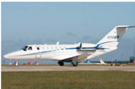
Рис. 5. Региональный самолет Cessna Citation J3. Коммерческая нагрузка 2670 кг, до 8 пассажиров или 3 носилок. Дальность полета 3470 км. Скорость полета 770 км/ч. Габариты салона 4,78 м • 1,47 м • 1,45 м.
