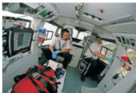
Рис. 4. Оборудование вертолета EuroCopter EC145 в санитарном варианте. Полная масса 3650 кг, до 9 пассажиров. Диаметр главного винта 11 м. Крейсерская скорость полета 256 км/ч. Дальность полета 705 км. Габариты пассажирской кабины (длина • ширина • высота) 3,42 м • 1,4 м • 1,22 м.
