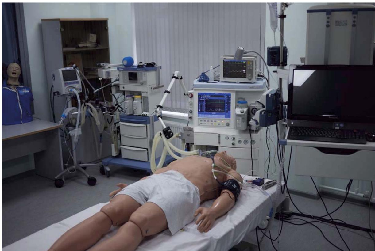
Рис. 4. Анестезиологический робот-симулятор.
