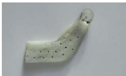
Рис. 11. Эндопротез на основе сополимера и дисперсного ГАП, армированный углеродным волокном.
