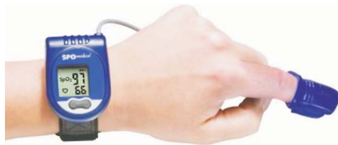
Рис. 1. Компьютерный пульсоксиметр PulseOx 7500 (SPO Medical, Израиль) с отражающей технологией регистрации сигнала, применяемый в отделении восстановительного сна санатория «Барвиха».
