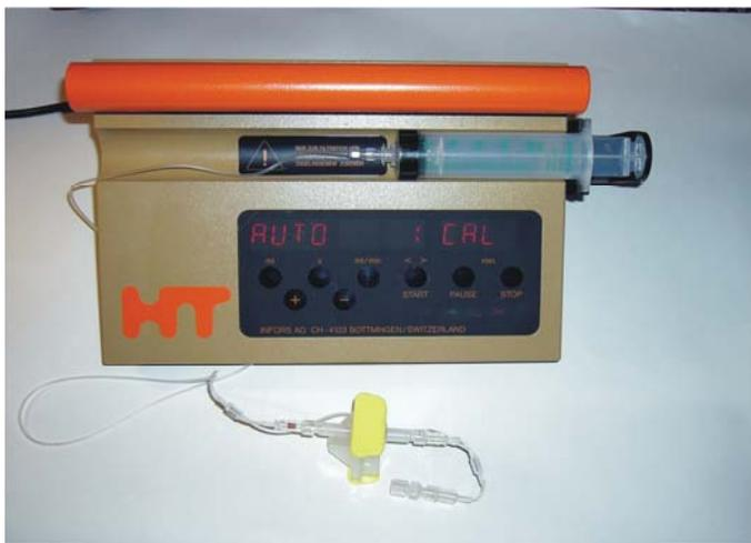
Рис. 1. Двухнаправленный шприцевой насос с фильтрующим элементом.
