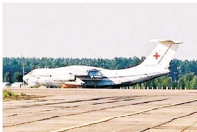
Рис. 2. Летящий госпиталь Ил-76МД "Скальпель МТ", разработан в ОКБ им. С.В. Ильюшина на базе военно-транспортного самолета Ил-76МД.
