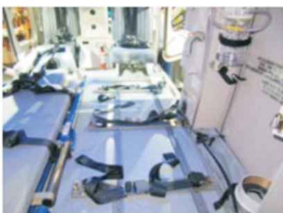
Рис. 6. Базовая компоновка популярного в СА США вертолета Bell 429 предусматривает два койко-места. Полная взлетная масса 3157 кг, до 6 пассажиров или 2 койки. Дальность полета 648 км. Скорость полета 264 км/ч. Диаметр главного винта 10,97 м. Объем пассажирской кабины 5,78 м 3 .
