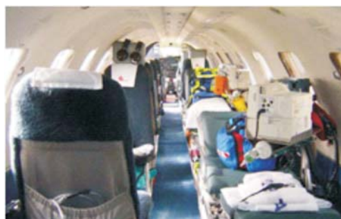
Рис. 3. Оборудование среднемагистрального самолета LearJet 35A в санитарном варианте. Полная нагрузка 1300 кг, до 6 пассажиров. Дальность полета 3700 км. Скорость полета 850 км/ч. Взлетно-посадочные полосы асфальтированные, длиной не менее 1400 м.
