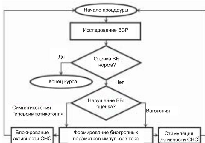
**Рис. 5. Алгоритм ДКАСНС при периферических функциональных нарушениях ВНС.**
