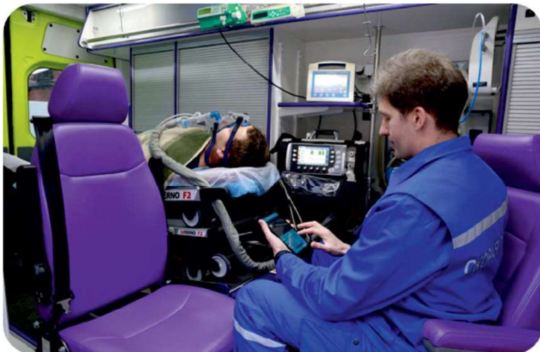
Рис. 6. Передача информации посредством планшетного компьютера от оборудования на борту автомобиля СМП на пульт старшего врача оперативного отдела.
